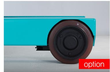
전문 브레이크 미끄럼 방지 브레이크 제어 드라이브 타이어가 미끄러질때 전문 브레이크가 작동합니다. 타이어 잠금을 방지하고, 최대 제동력을 제공하며 포크리프트가 안정화되고 제동 거리가 최소화됩니다.
